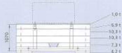
40 t Gegengewicht 40 t counterweight 40 t de contrepoids
